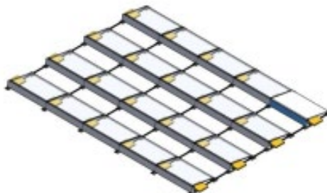
Slika 6: Prikaz ugradnje vjetrobrana
